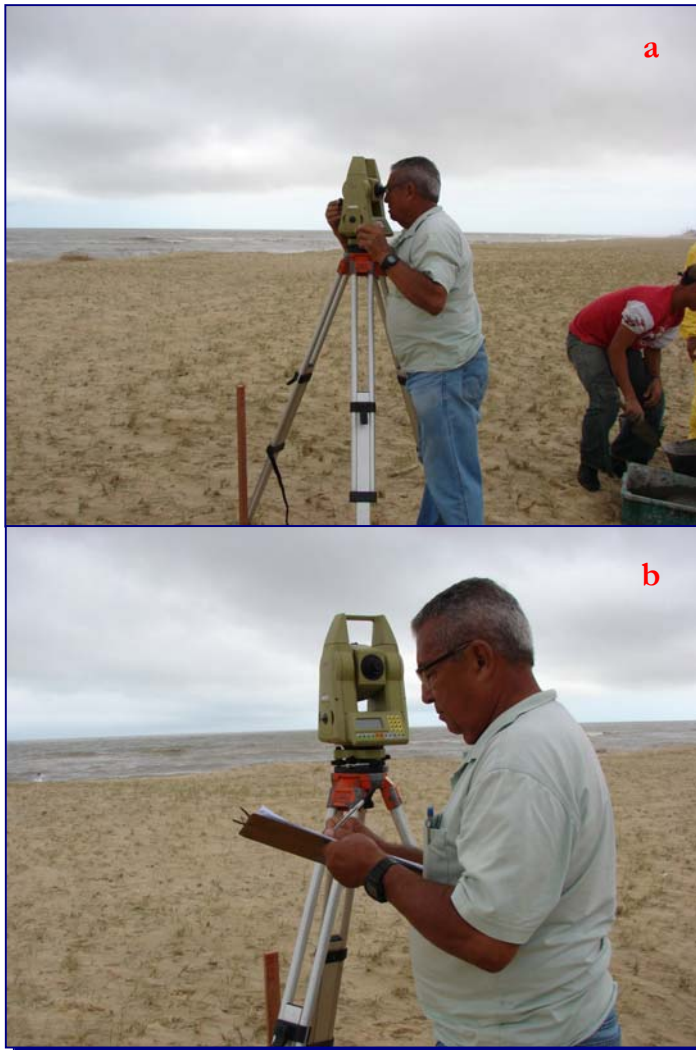
Fotos 16a e 16b: Medições dos perfis topográficos de praia através do emprego de estação total: (a) observação da posição do prisma através da estação e (b) anotações de qualquer tipo de anomalia, ou detalhe, que se queira registrar.
